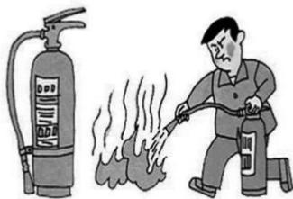
下灭火器开启把上的保险销，然后一只手握住喷射管前端，对准燃烧点根部，另一只手将开启压把压下，打开灭火器进行灭火。
